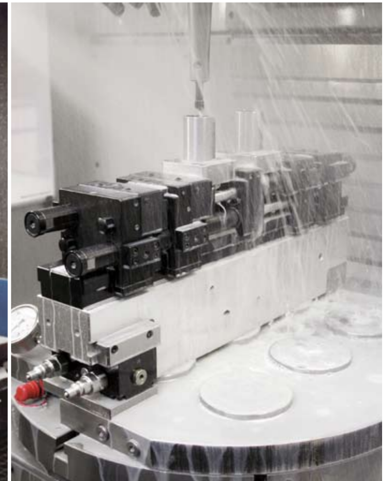
> Hydraulisches Mehrfachspannsystem in Verbindung mit dem AMF Zero-Point-System > Hydraulic multiple clamping system in conjunction with the AMF zero point system
