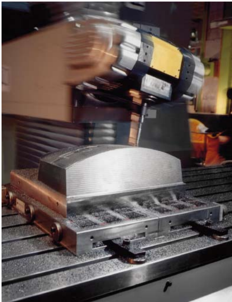
> Vielseitige Anwendung der AMF-Magnetspanntechnik bei der spanenden Bearbeitung > Versatile use of AMF magnetic clamping technology in machining
