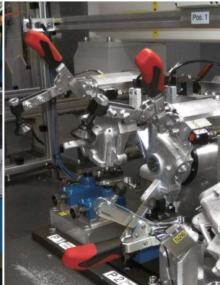
> AMF-Schnellspanner in Anwendung auf einer komplexen Prüfvorrichtung > AMF toggle clamp on a complex test fixture
