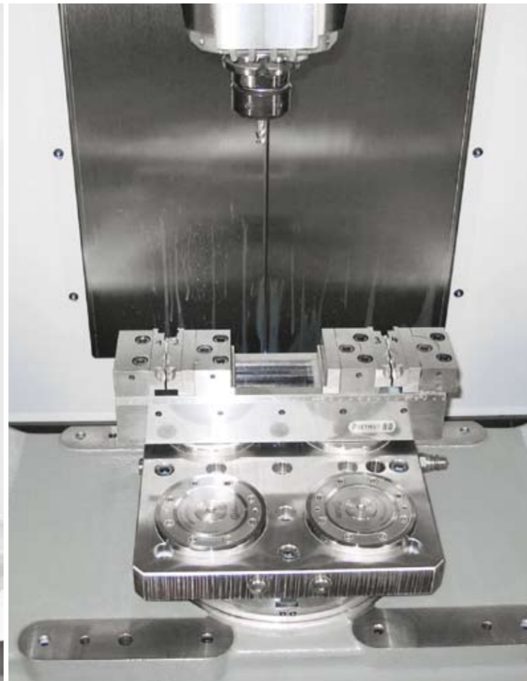
> Rüstzeitoptimierter Wechsel mit dem AMF Zero-Point-System > Optimised changeover times with the AMF zero point system
