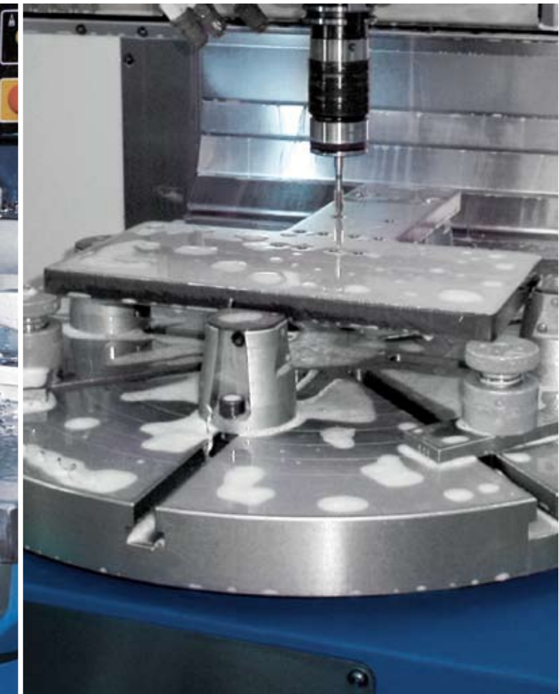
> Innovativer Niederzugspanner ermöglicht das erhöhte Spannen von Werkstücken > Innovative pull-down clamp enables increased workpiece clamping
