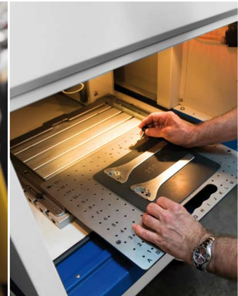
> Punktgenaues Positionieren unterschiedlichster Anwendungen bei der Laserbeschriftung > Precision positioning of various laser marking applications
